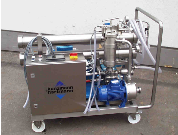
VinOsmo RO 100 Kompaktanlage mit 100 l/h Wasserentzug
